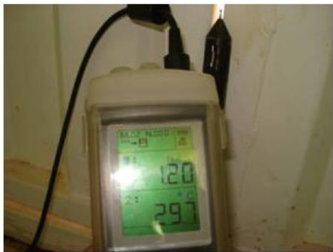
اندازه‌گیری میزان نشت و نفوذ ساختمان
