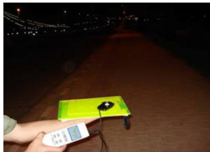
نمونه‌ای از اندازه‌گیری‌های شدت روشنایی محوطه
