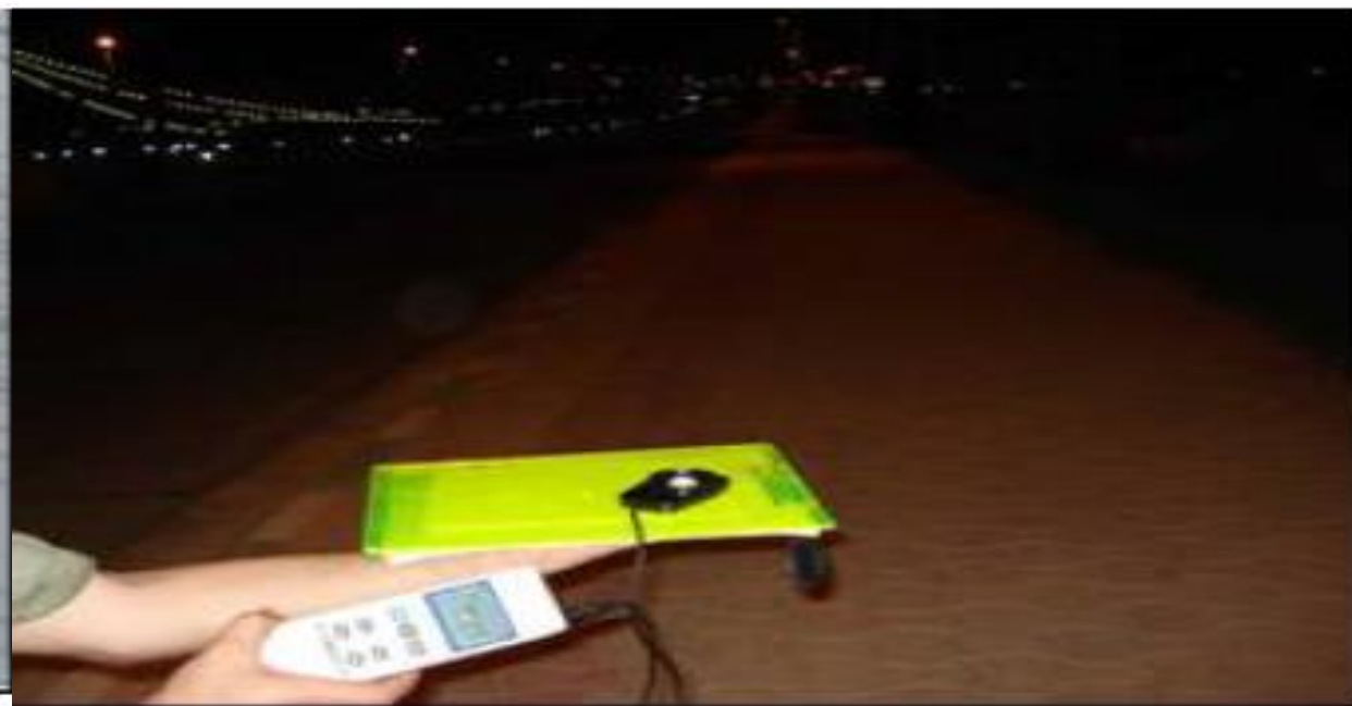
نمونه ای از اندازه گیری های شدت روشنایی محوطه
