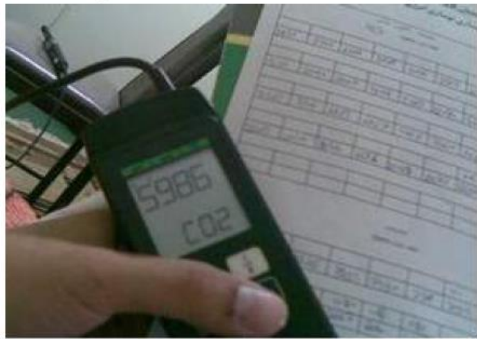
اندازه‌گیری میزان نفوذ هوا از روش گاز ردیاب
